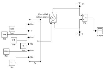
Fig. 2. Photovoltaic array
