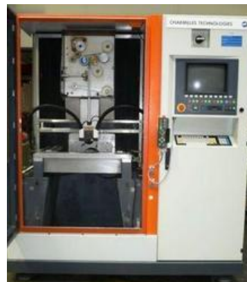
Fig. 1 Robofil-290 CNC wire EDM
